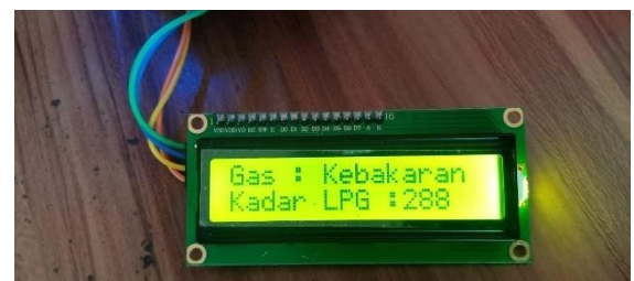
Gambar 3. 8 Pengujian Tampilan Kebakaran
