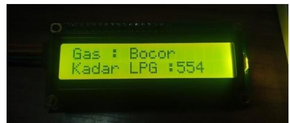
Gambar 3. 7 Pengujian Tampilan LCD Bahaya
